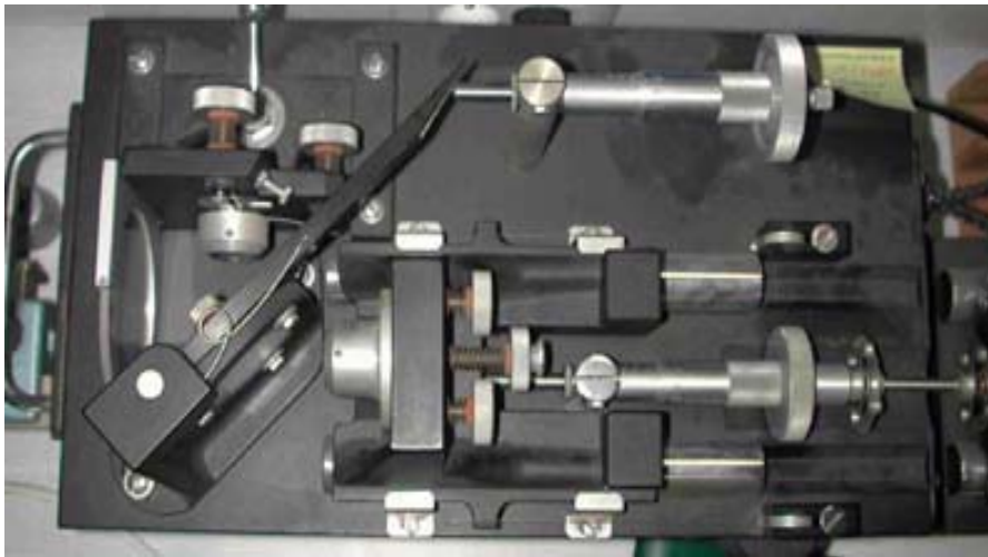
FIG. 4.16 – Photographie d'un interféromètre de Michelson. On reconnaît le chariot en bas à droite, la séparatrice et la compensatrice en bas à gauche et les deux miroirs à 90^\circ dont l'un est porté par le chariot.
