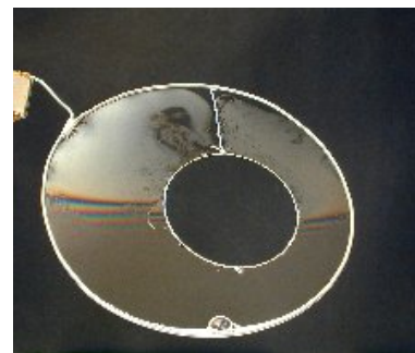
Fig. 4.3 – Mise en évidence des forces capillaires
