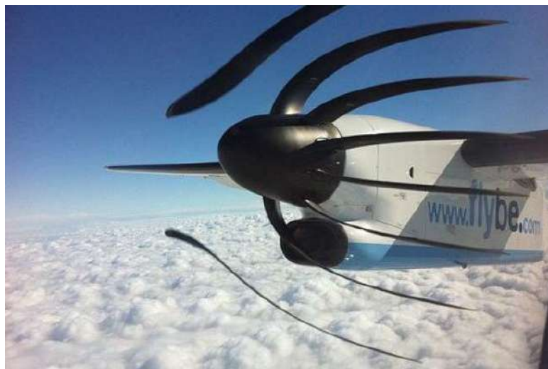
Un autre exemple de représentation faussée par le Rolling Shutter sur un mouvement de rotation
