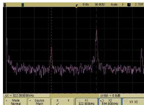
Spectre du signal à la sortie du multiplieur FFT à 2 MHz
