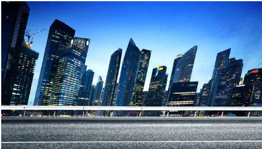
Sur cet exemple d'une photo prise dans une voiture en mouvement, le déplacement du véhicule de la gauche vers la droite associée à l'enregistrement de haut en bas de l'image engendre une inclinaison vers la droite des bâtiments (on peut faire le test avec son smartphone)
