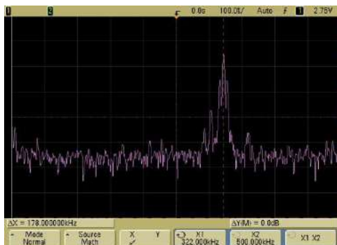
Spectre du signal v_d FFT à 1 MHz
